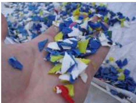
Figura 5. Hojuelas de PET como materia prima para el proceso de extrusión.
